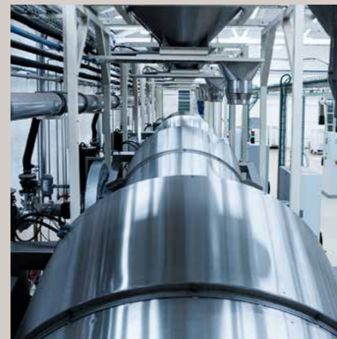
Figura 1. Tecnologia Naturity® che rimuove il TCA e centinaia di altri composti volatili mediante il processo di desorbimento termico con un impiego opportunamente calibrato, non sequenziale, di pressione, temperatura, acqua purificata e tempo.
